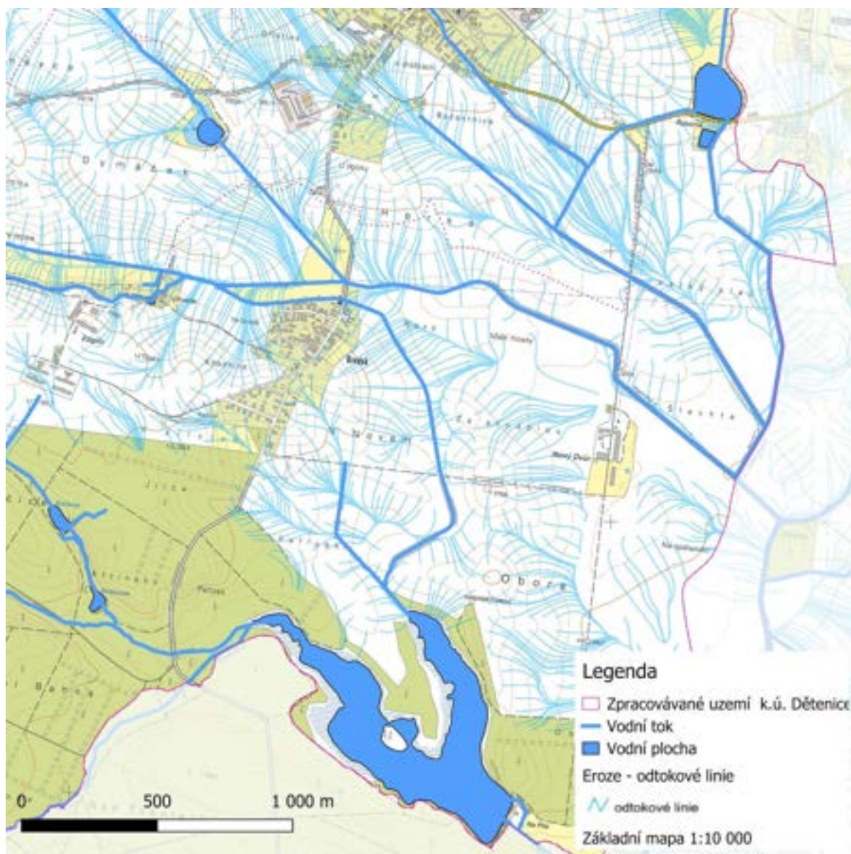
Obrázek 32: Odtokové linie v jihovýchodní a střední části území obce Dětenice. (Zdroj: Grafická část studie/QGIS; ZM 10, ČÚZK, cit. 2025)
