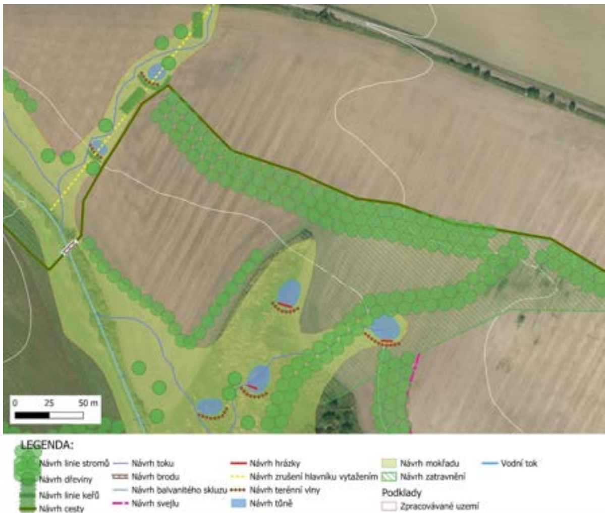
Obrázek 101: Krajinná opatření v zemědělské části lokality Na Lhotsku zvyšují retenční schopnost svahů, přerušuje povrchový odtok a zajišťují filtraci splachů ještě před vstupem do mokřadní části údolnice. (Zdroj: Návrhy v rámci studie, QGIS; ortofotomapa, Google Maps, 2025)
