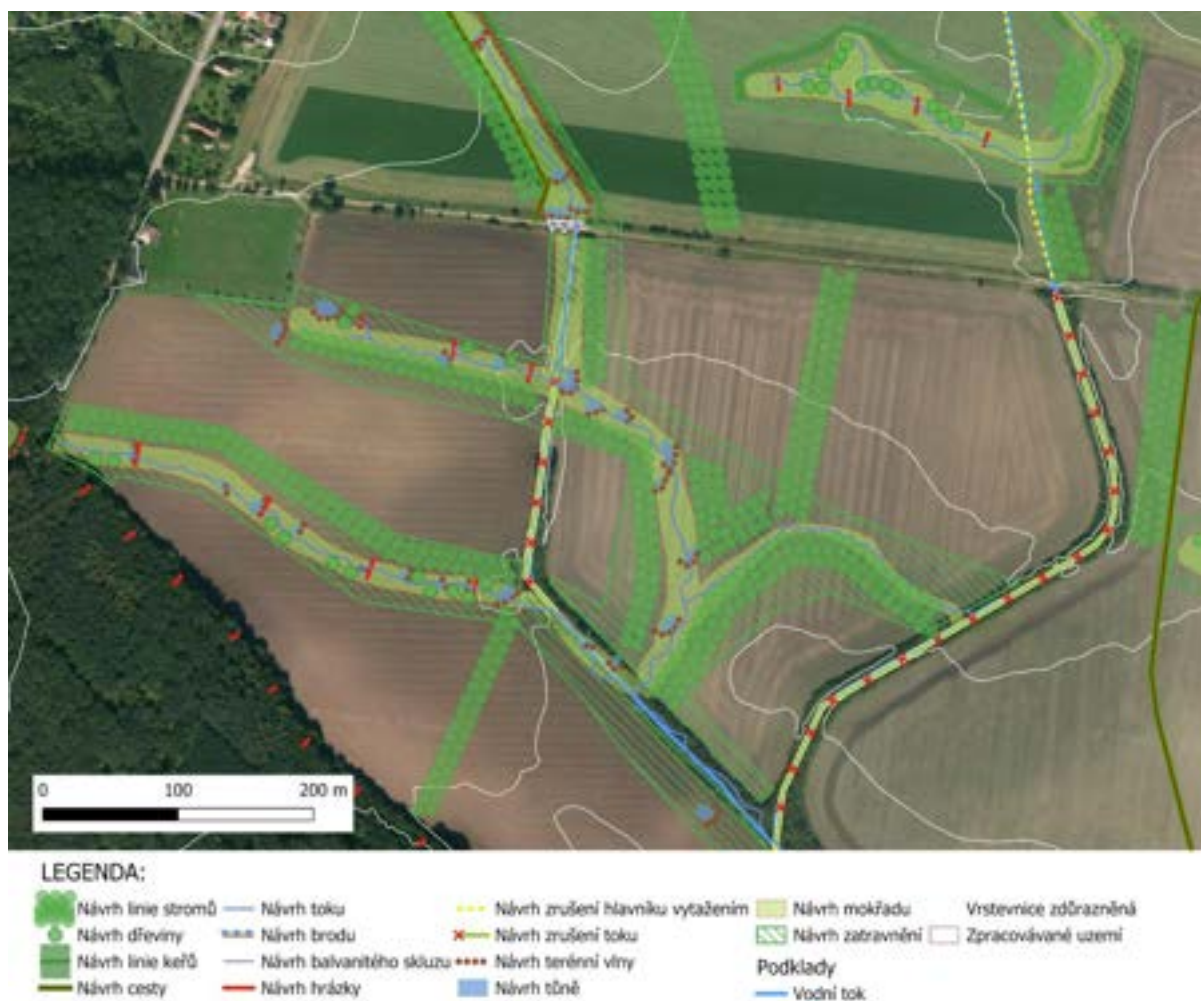
Obrázek 116: Návrh revitalizace odvodňovacích kanálů v lokalitě Pařízek. Záměrem je vytvoření soustavy tůní, mělkých depresí a litorálních ploch napájených vodou z drenáží. Vodoteč z náhonu při pravém okraji obrázku je odpojena od aktivního odtoku a ponechána pouze jako historický a krajinařský prvek. (Zdroj: Návrhy v rámci studie, QGIS; Ortofotomapa, Google Maps, 2025)
