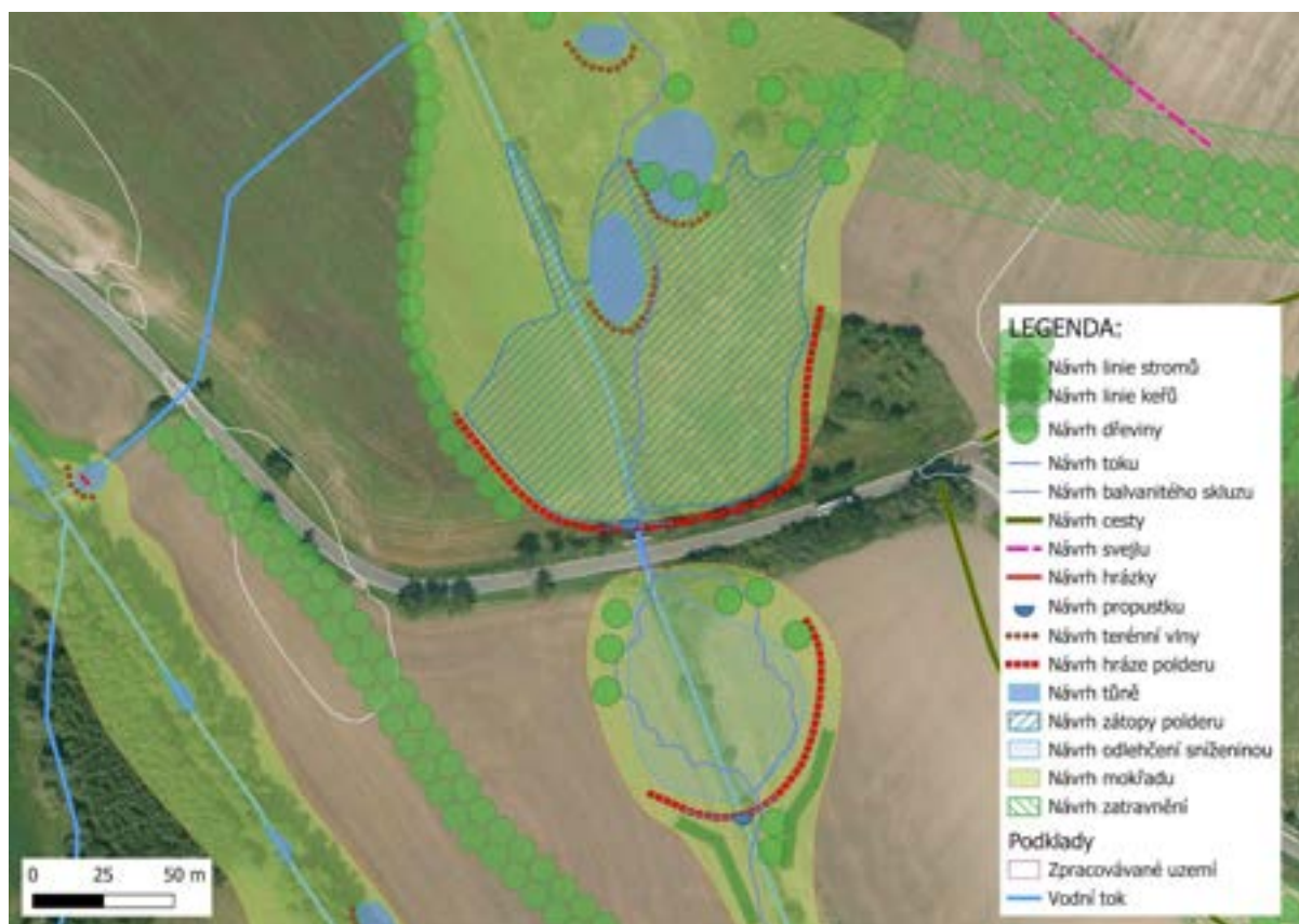
Obrázek 98: Návrh poldrové soustavy a revitalizace nivy v lokalitě Na Lhotsku. Obnova mokřadu na místě zaniklého rybníka, navržené retenční hrázky s balvanitými skluzovými přelivy, nový přirozený tok Rokytňanského potoka. (Zdroj: Návrhy v rámci studie, QGIS; ortofotomapa, Google Maps, 2025)
