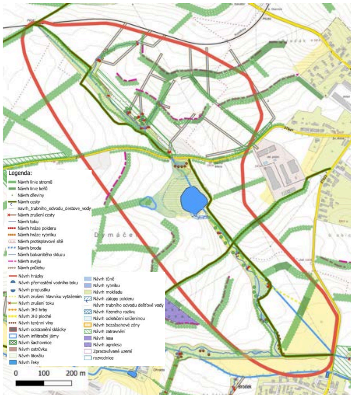
Obrázek 90: Souhrnný návrh krajinných a hydrologických opatření v povodí Dětenického a Osenického potoka. (Zdroj: Návrhy v rámci studie, QGIS; ZM5, ČÚZK, 2025)
