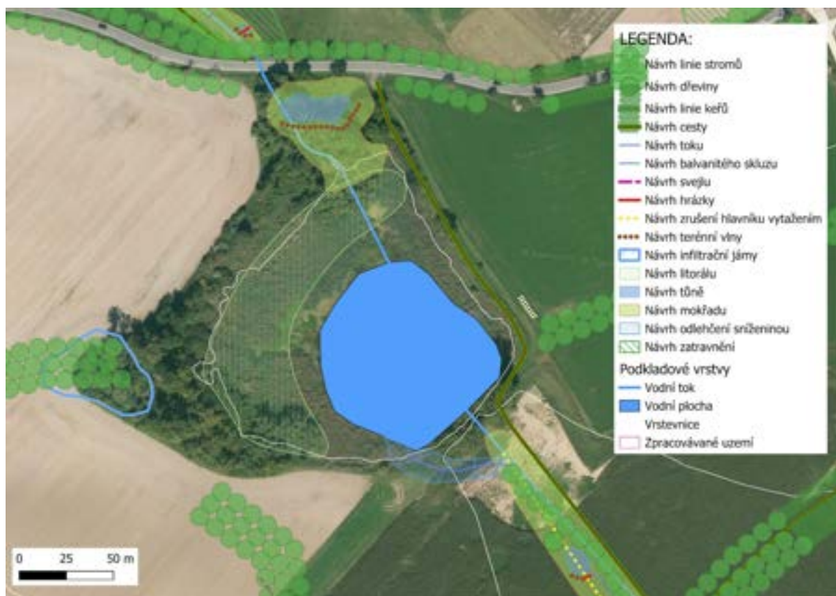
Obrázek 92: Návrh revitalizace nádrže Suchánek a okolních mokřadních prvků. Plánované technické úpravy nádrže, obnova mokřadních ploch a stabilizační výsadby či retenční prvky zachycující povrchový i podpovrchový odtok. (Zdroj: Návrhy v rámci studie, QGIS; ortofotomapa, Google Maps, 2025)
