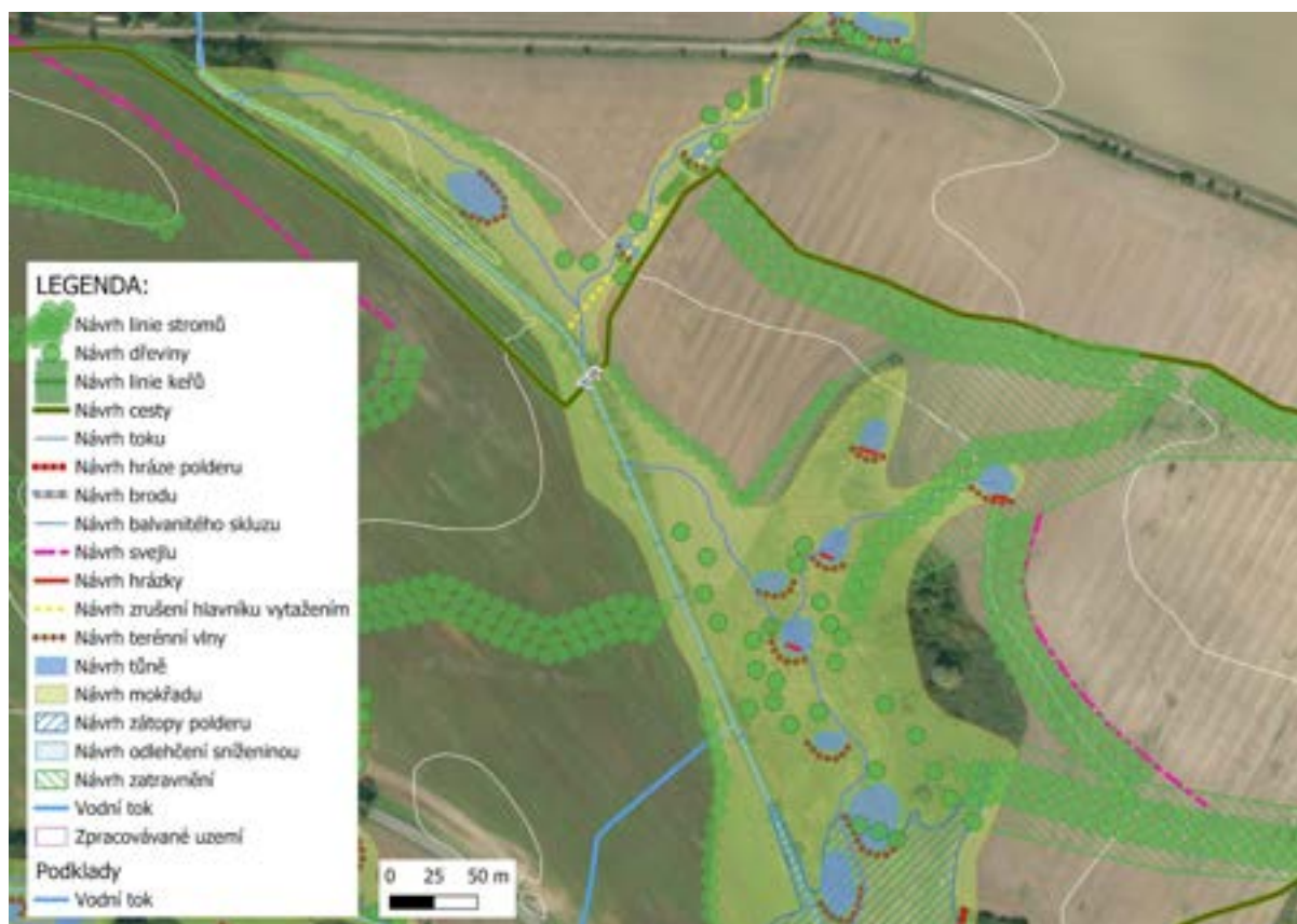
Obrázek 97: Revitalizace mokřadu a obnovu přirozené nivy Rokytnánského potoka v lokalitě Na Lhotsku. (Zdroj: Návrhy v rámci studie, QGIS; ortofotomapa, Google Maps, 2025)
