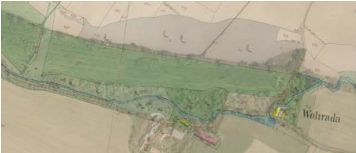
Obrázek 36: Promítnutí CO a ortofotomapy se zakresleným vodním tokem/náhonem a vodním mlýnem v osadě Wohrada. Levý břeh současného toku je zalesněn, kolem náhonu vede cesta. (Zdroj: Ortofotomapa ČÚZK, 2025; Císařské otisky stabilního katastru Čech, ČÚZK, 2025; Grafická část studie/QGIS, 2025)
