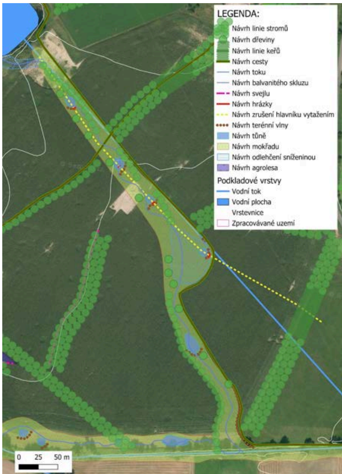
Obrázek 94: Návrh revitalizace toku pod nádrží Suchánek – odstranění zatrubnění, odklonění tokové línie a vytvoření přírodně blízkého koryta. Mapa zobrazuje nově navrženou trasu toku mimo ochranné pásmo vrtu. (Zdroj: Návrhy v rámci studie, QGIS; Ortofotomapa, Google Maps, 2025)
