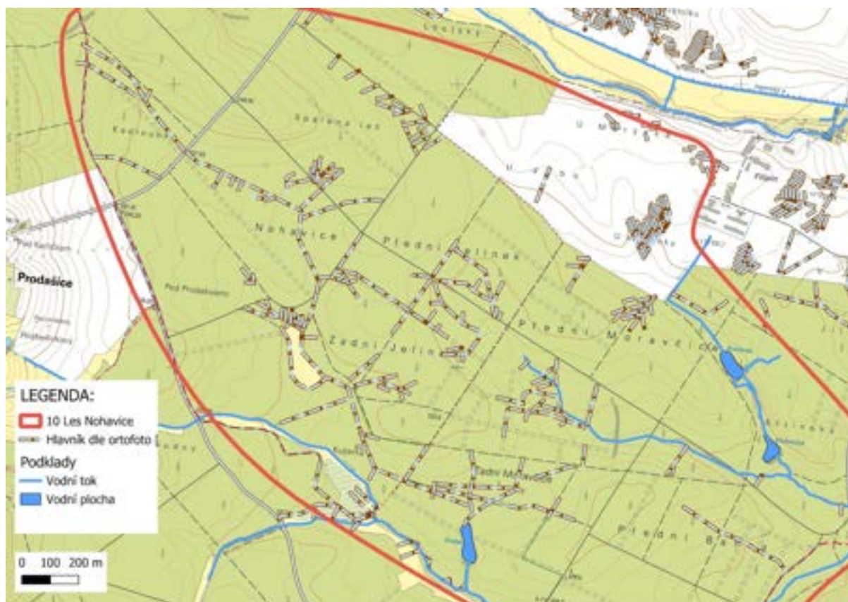
Obrázek 73: Zakreslení melioračních příkopů v Dětenickém lese. Je zřejmé, že odvodnění významně zasahuje do vodního režimu území.
